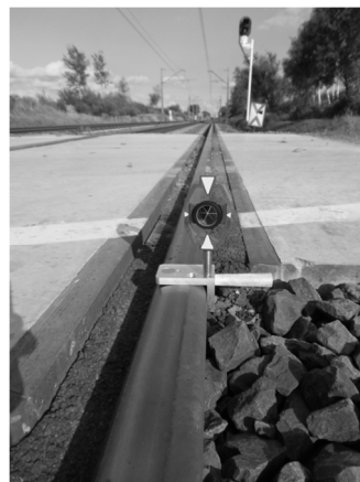
Rys. 7. Prawidłowe przyłożenie minipryzmatu GMP111 do szyny typu kolejowego z przykładnicą magnetyczno-pomiarową (fotografia własna)
