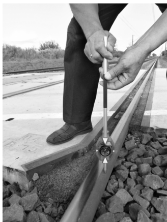
Rys. 6. Nieprawidłowe przyłożenie minipryzmatu GMP111 do szyny typu kolejowego (fotografia własna)
