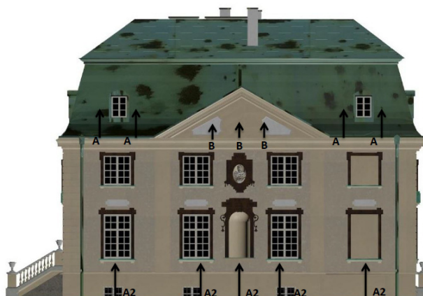
Rys. 5. Rozmieszczenie opraw, fasada południowa [3]
