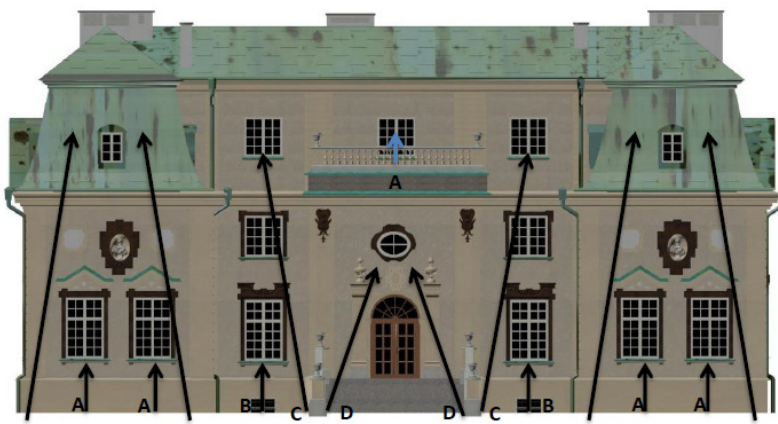
Rys. 7. Rozmieszczenie opraw, fasada zachodnia [3]
