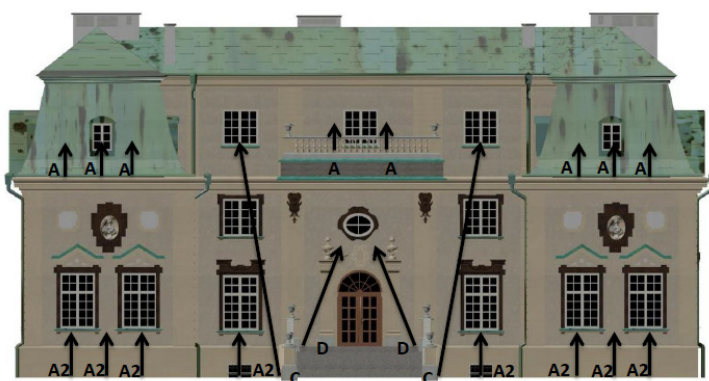
Rys. 4. Rozmieszczenie opraw, fasada zachodnia [3]
