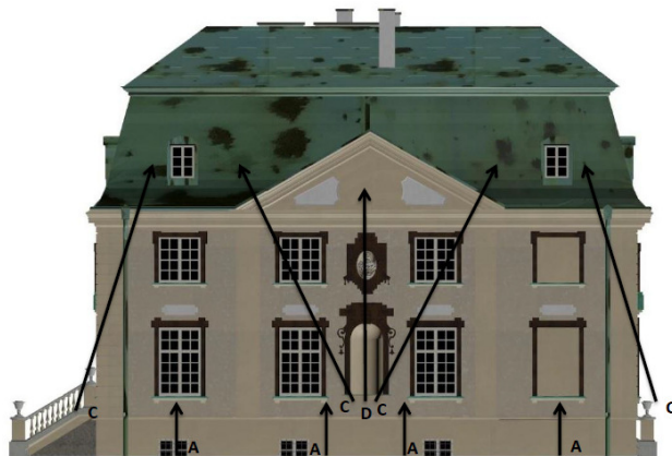
Rys. 8. Rozmieszczenie opraw, fasada południowa [3]
