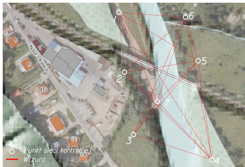
Rys. 4. Projekt sieci kontrolnej (podkład projektu na podstawie: [31])
