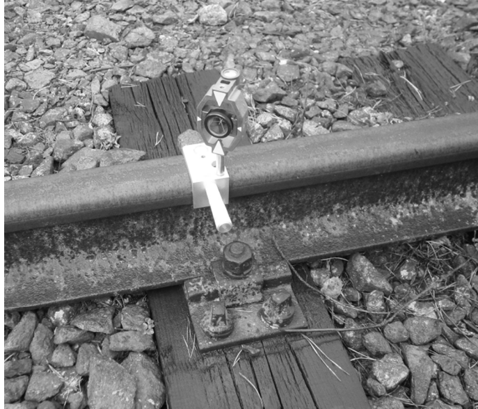
Rys. 6. Przykładnica magnetyczno-pomiarowa z minipryzmatem GMP111 (fotografia własna)
