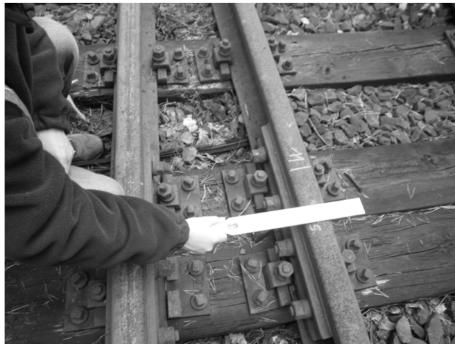
Rys. 5. Smyczek pomiarowy w płaszczyźnie poziomej (fotografia własna)
