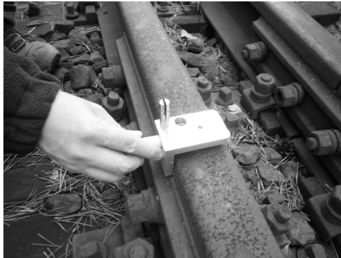
Rys. 4. Przykładnica magnetyczno-pomiarowa z linką pomiarową (fotografia własna)
